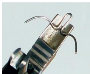
⑤脚部の高さ分、上に出して把持し、脚部を後方に折り曲げる
