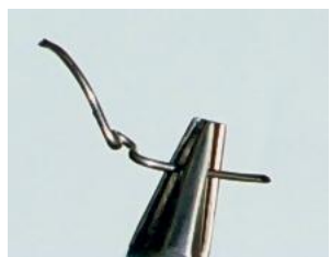
河辺式プライヤー ⑥鉤腕部細部を屈曲し 最終仕上げをする
