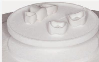
ビーズを回収する手間もなく効率アップ。シンタリング時は、修復物の咬合面をシンタリングトレイ側にして配置するだけ。
